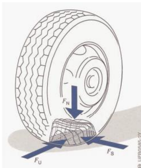
Figura 15 - Forças que atuam no pneu durante uma frenagem em curva.
